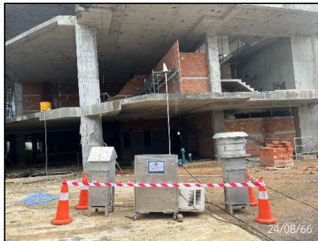
รูปที่ 4.3.1-13 ตัวอย่างแสดงการตรวจวัดคุณภาพอากาศ ภายในพื้นที่โครงการ
