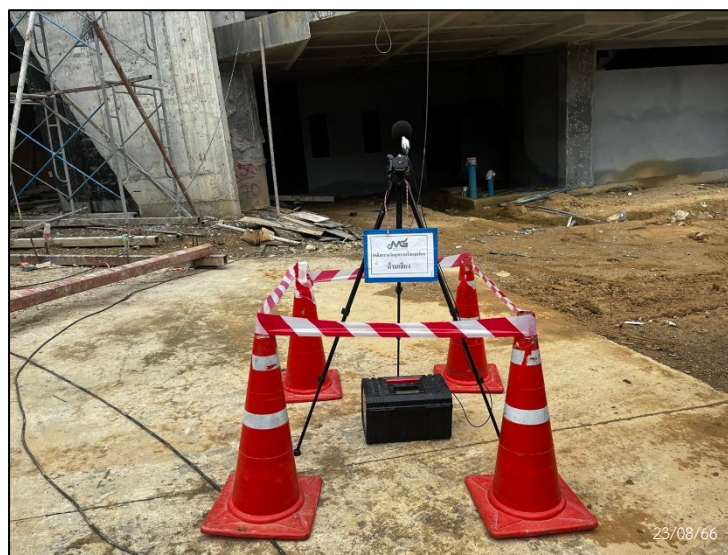
รูปที่ 4.3.2-7 ตัวอย่างแสดงการตรวจวัดระดับเสียงโดยทั่วไป ภายในพื้นที่โครงการ
