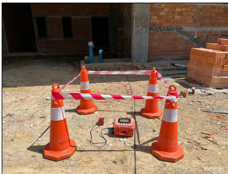
รูปที่ 4.3.3-1 ตัวอย่างแสดงการตรวจวัดความสั่นสะเทือน ภายในพื้นที่โครงการ
